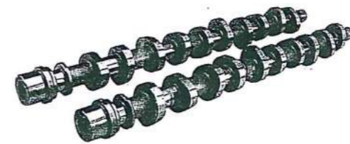
Figura 8.2 Coppia di alberi a camme per motore 10 cilindri a V; nel dettaglio, camme con angolo di salita molto stretto.
