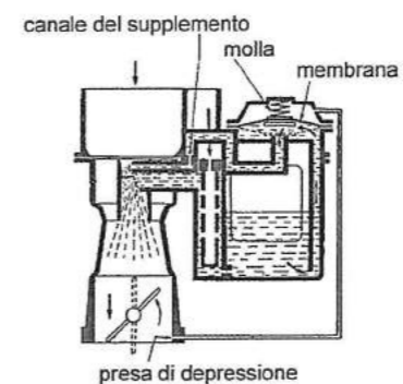
Figura 3.4 - A sinistra, carburatore visto dall'alto: A) presa d'aria vaschetta; B) presa di depressione del minimo e dello starter; C) farfalla dello starter; D) tubo entrata benzina; E; levetta azionamento starter. A destra, pompa di ripresa pneumatica (Weber).
